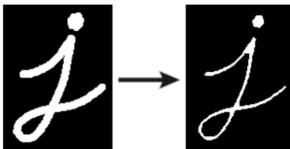
Obrázok 3–4 Ukážka úpravy obrazu operáciou erózie
