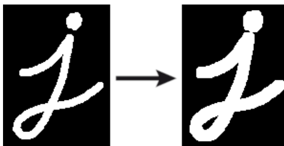
Obrázok 3–5 Ukážka úpravy obrazu operáciou dilatácie
