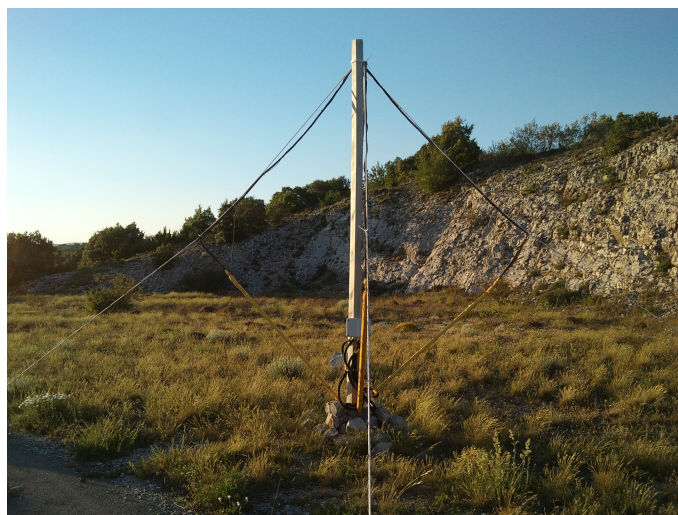
Obrázok 3–1 Jedna z troch častí VLF analyzátoru ELMAVAN-G určeného na príjem signálov vo frekvencii do 25\text{ kHz} . Zdroj: http://bleska.ufa.cas.cz/labb/pics_s/vlf_big.jpg
